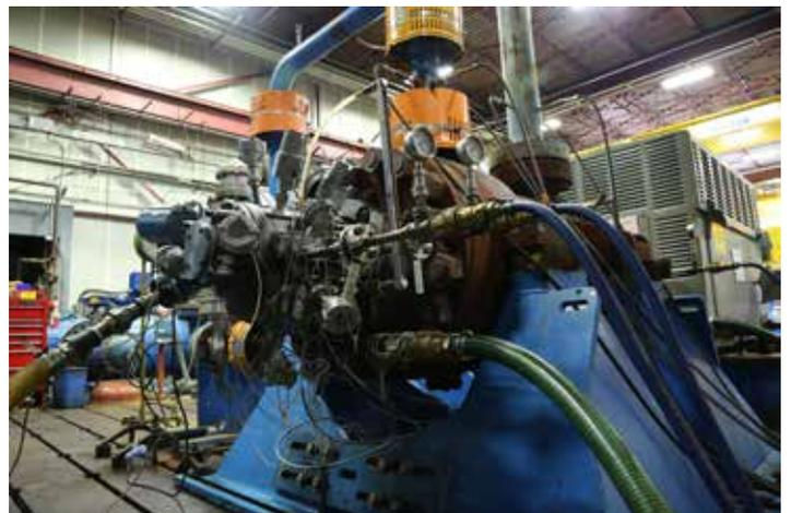
Le boîtier de roulement est soumis à des tests rigoureux.
